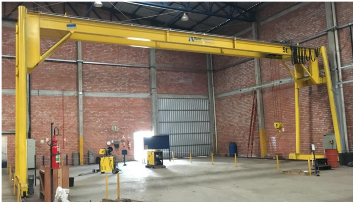
Figura 6: Ponte rolante 5,00 t x 15,00 m.
