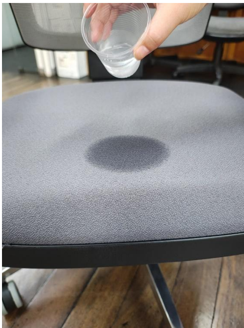
Figura 4- Registro fotográfico do teste de impermeabilidade realizado – item 1 do Lote 1.
