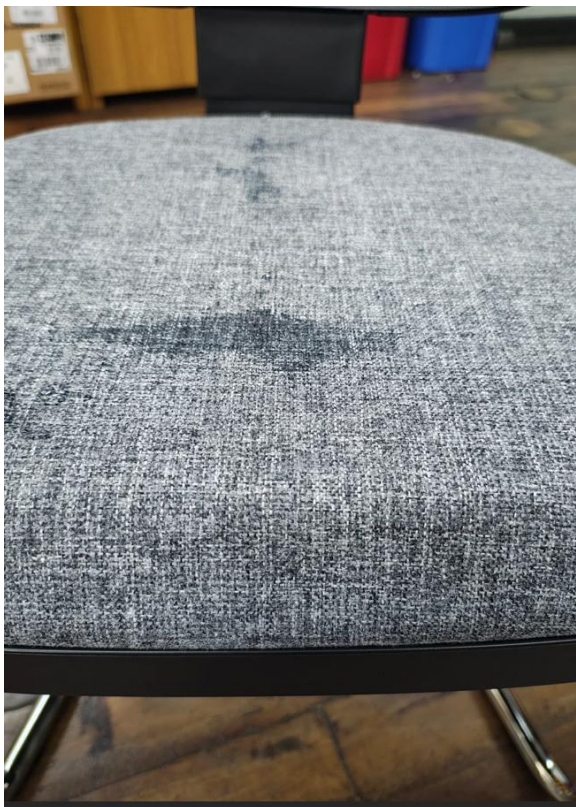
Figura 11 - Registro fotográfico do teste de impermeabilidade realizado –item 3 do Lote 1.
